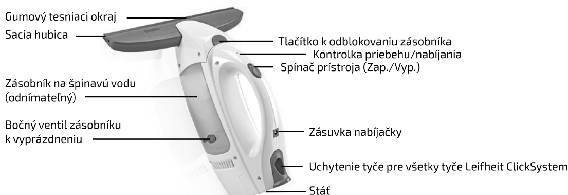
Obrázok 2: Obslužné prvky okennej odsávačky
